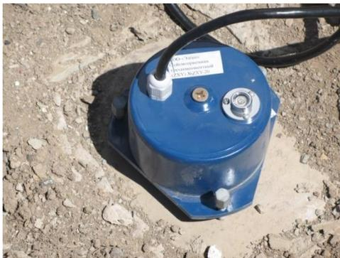
Рис. 6. Установка сейсμοприемника на бетонном основании
