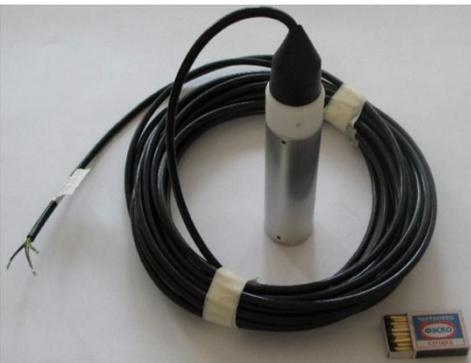
Рис. 7. Сейсμοприемник для скважинной установки
