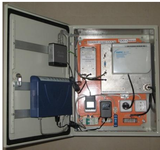
Рис. 13. Полевой пункт системы СССР для подземной установки
