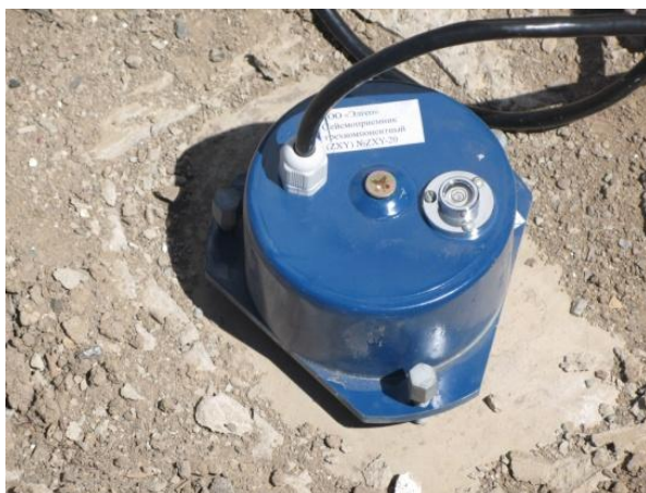
Рис. 10. Установка сейсмоприемника на бетонном основании
